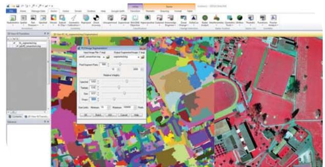
ERDAS IMAGINE ofrece más soluciones de clasificación que cualquier otro producto en el mercado, incluyendo K-Means, ISODATA y segmentación basada en objetos.
